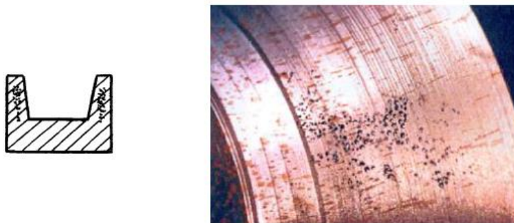
Рисунок 9. Дефект – усадочная пористость: а – схема; б – дефектная отливка
