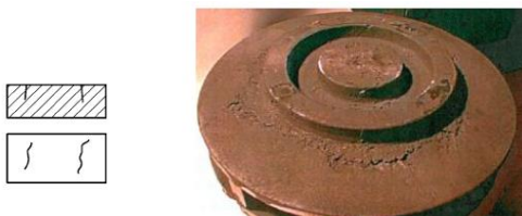
Рисунок 5. Дефект – горячие трещины: а – схема; б – дефектная отливка
