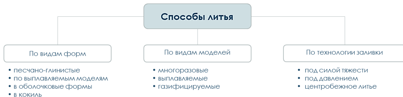
Схема 1. Классификация способов литья
