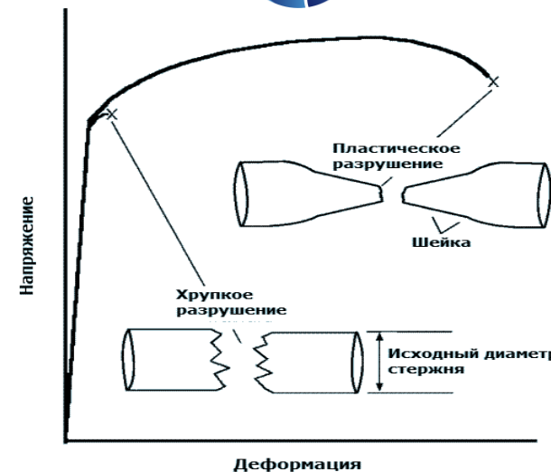
У хрупкого материала отсутствует или незначителен переход из упругого в пластическое состояние. Нет площадки текучести, почти не деформируются – разрушаются
