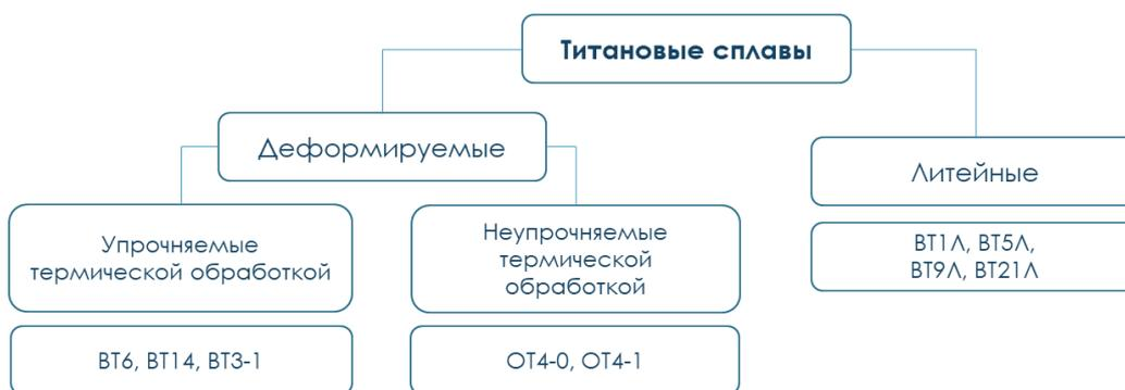
Схема 1. Классификация титановых сплавов по технологическим признакам
