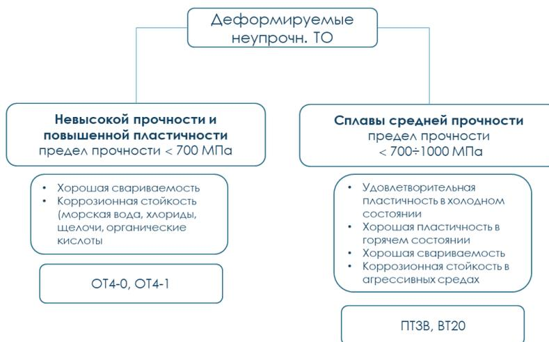
Схема 2. Классификация деформируемых сплавов неупрочняемых термической обработкой
