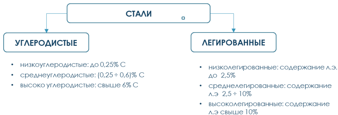
Схема 4. Классификация сталей по химическому составу
