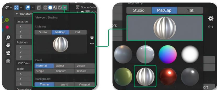
Отражения и блики помогают оценить плавность поверхности под сглаживанием. Важно чтобы блик был ровный, а поверхность гладкая. В проблемных местах блик на поверхности имеет деформацию.
