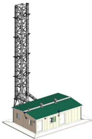
Газовая котельная, модель в Autodesk Revit. Изображение предоставлено ООО «ТеплоЭнергоСервис-Проект»
